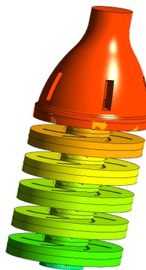
Figure 7.5: Répartition de pression de la pompe SM80-125/6 sous le module CFX-POST
