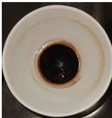
Figure 3.15 Huile pyrolytique après sa mise dans le four à 80°C
