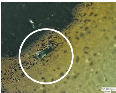
Figure 3.9 Observation microscopique des particules fines dans la biohuile \times 10 D'après ces observations, la différence des deux phases dans les huiles exige l'homogénéisation des biohuiles avant l'échantillonnage (par exemple le mélangeage de la biohuile avant l'échantillonnage) (Mohan et al., 2006).
