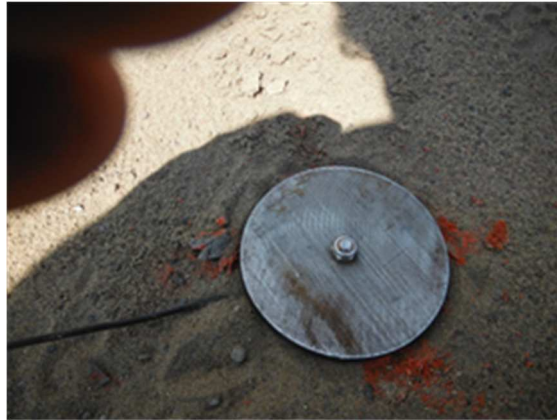
Figure 2.12 Installation des électrodes de géophysique et de leurs fils
