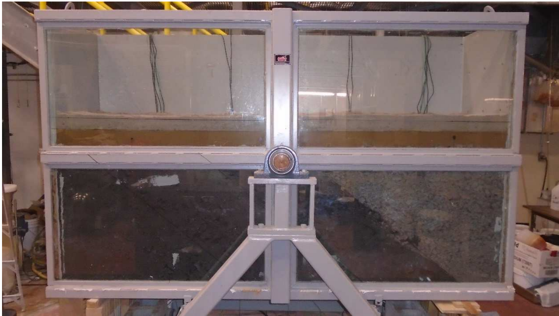
Figure 3.7 Modèle physique 2D après la mise en place des trois couches de différents matériaux
