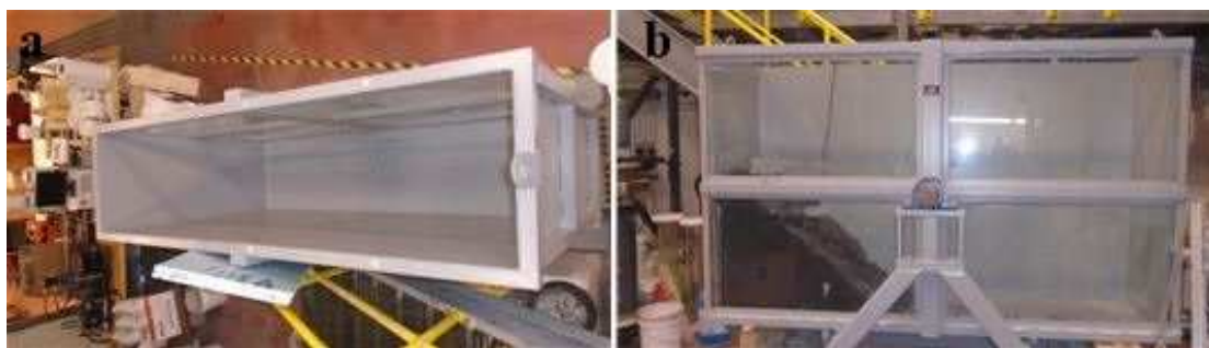
Figure 3.3 Vue d'ensemble du modèle physique 2D avant (a) et au début de son remplissage avec les matériaux (b)
