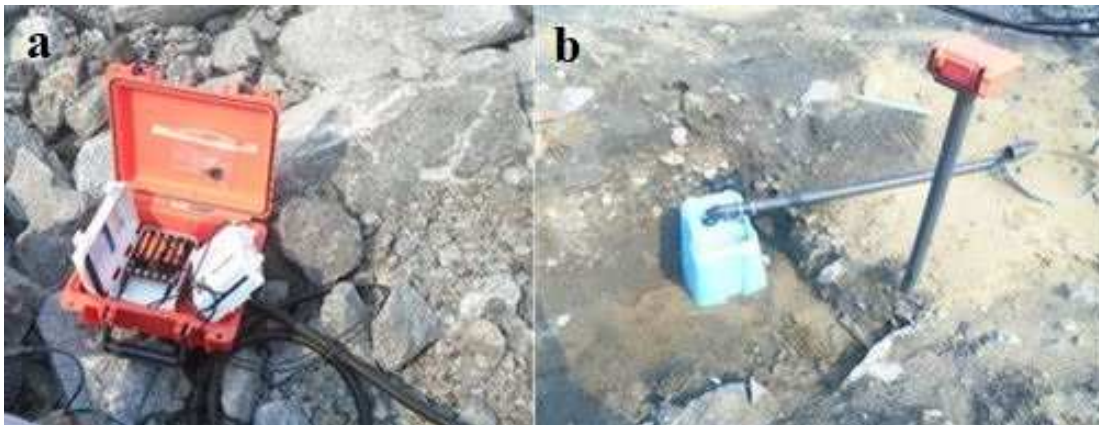
Figure 2.17 Datalogger mis dans une boîte de protection (a) et l'ensemble suspendu (b)
