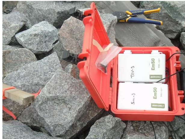
Figure 2.22 Boîte de protection des modules d'enregistrement des données de sondes de teneur en eau et de succion, posée sur la berme latérale droite
