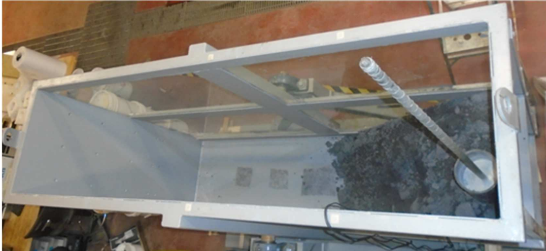
Figure 3.5 Installation des géotextiles à la base du modèle physique et compactage des matériaux
