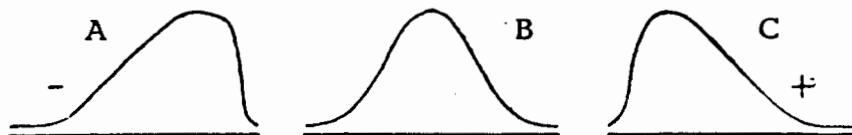
Figure 2.7. — Trois courbes de fréquences avec différents degrés de symétrie: la première (A) est négativement dissymétrique, la deuxième (B) est symétrique, et la troisième (C) est positivement dissymétrique.
