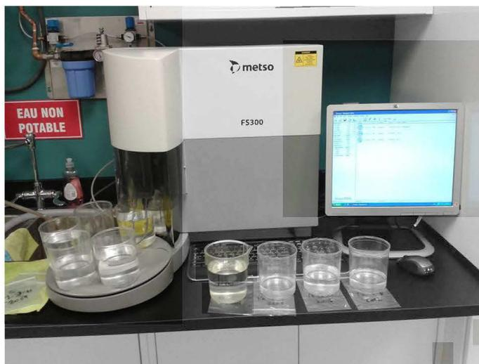
**Figure 3.5** Analyseur de fibres Kajaani FS300 de Metso<sup>®</sup>
