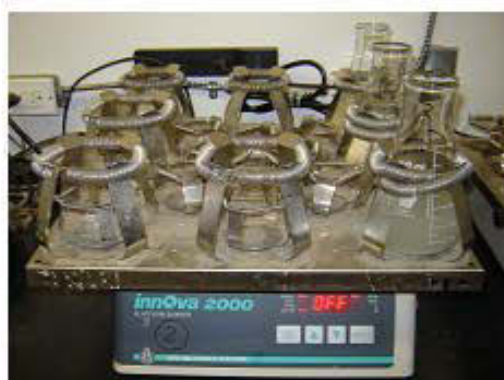
Figure 3-7: Photographie des essais de sorption agités
