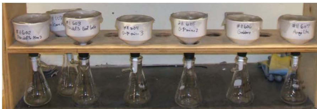
Figure 3-5: Photo des mini-cellules d'altération de cette étude
