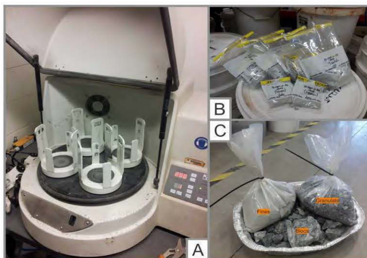
Figure 3.7 : La pulvérisette Fritsch (A), les échantillons fins (B) et le matériel restant (C)
