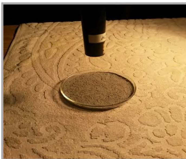
Figure 3.17 : Méthode d'acquisition des spectres avec la boîte de Pétri
