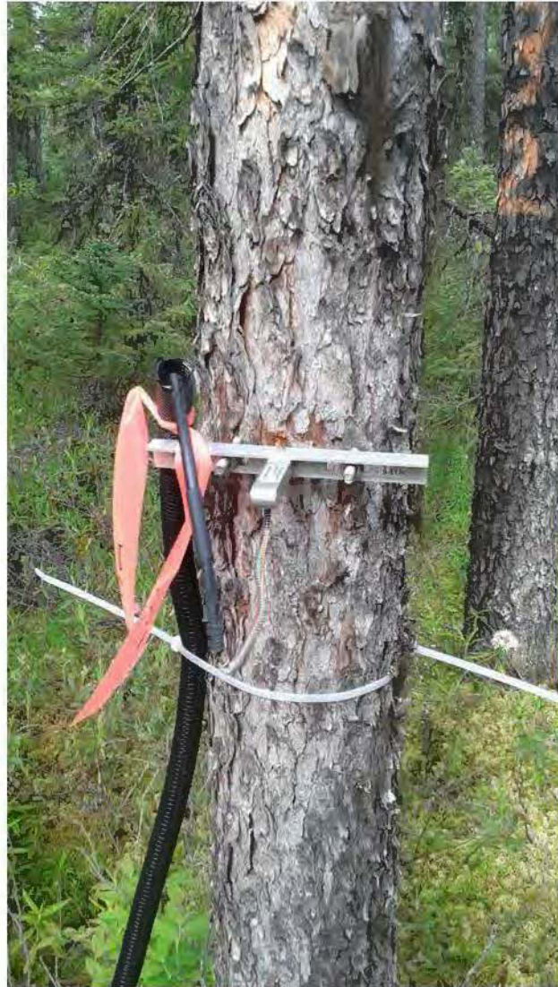
Figure D.1 Dendromètre installé sur le tronc d'une épinette noire
