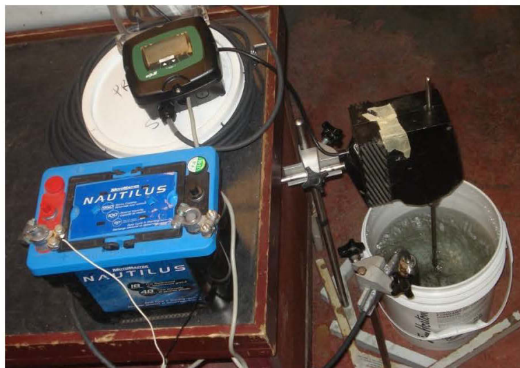
Figure H.1 Photo du système de mesures de la MES lors de la calibration au laboratoire.
