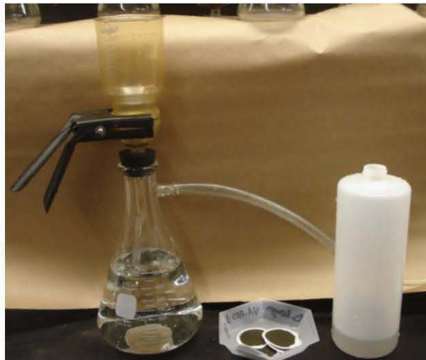
Figure E.3 Photo de la filtration à l'aide d'un filtre de 0,45 \mu\text{m} .
