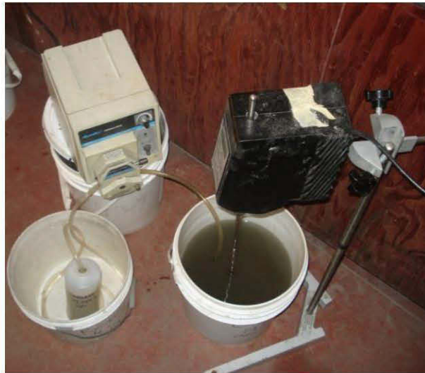
Figure E.2 Photo du système de simulation de la mesure de la MES.
