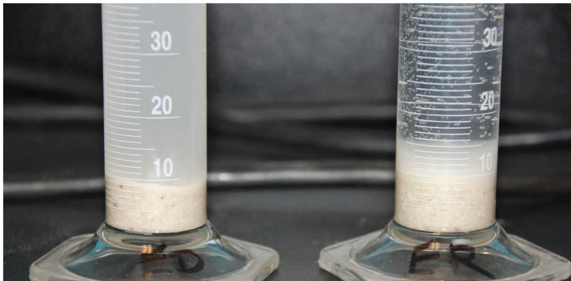
Volumes finaux de l'essai de gonflement libre de la bentonite dans l'eau déionisée (ED) et l'eau du robinet (ER).
