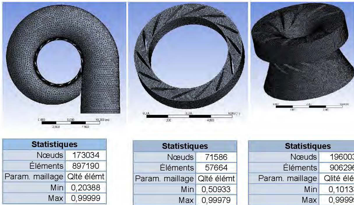
Figure 5-10 Maillage de : la bêche spirale (À gauche), les directrices (Au centre), la roue (à droite)
