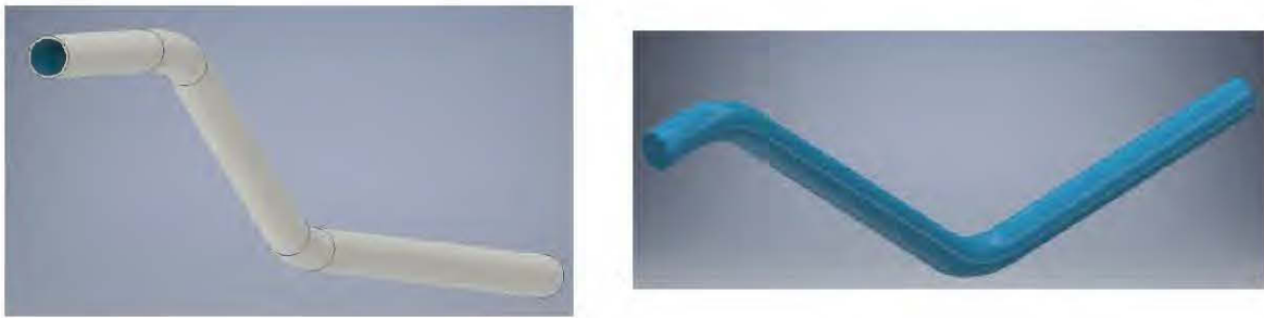
Figure 5-2 CAO de la conduite forcée : (À gauche) Modèle solide ; (À droite) Modèle liquide
