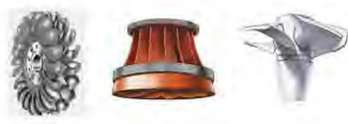
Figure 2-2 Turbines: Pelton (à gauche); Francis (Au milieu); Kaplan (à droite) [7]
