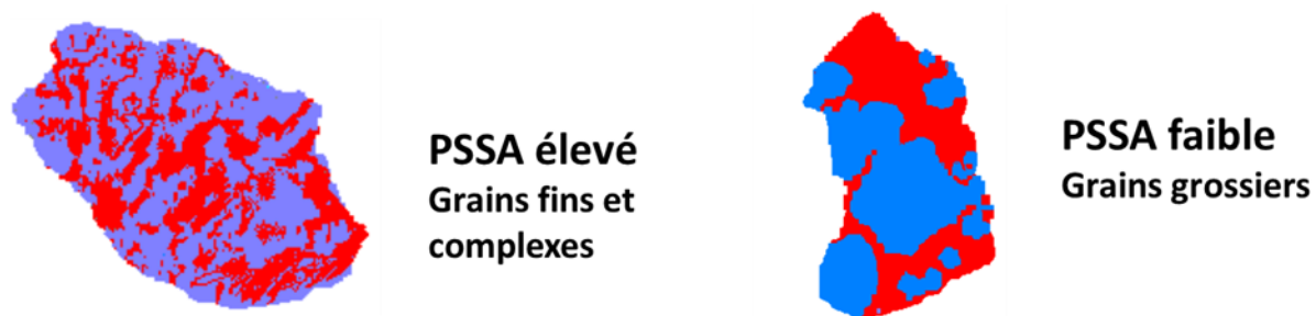
Figure 2.34 Exemple de mesure PSSA selon la texture minérale d'un MI (rouge) au sein d'un grain mixte.
