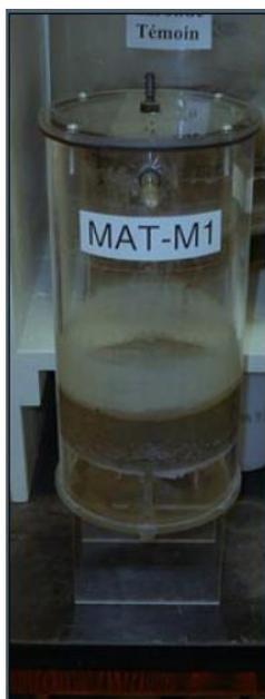
Figure 2.7 Photographie d'un essai en cellule humide (Villeneuve, 2004)
