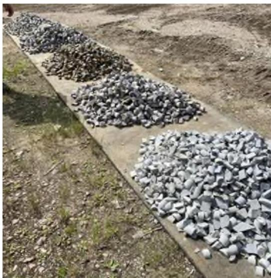
Figure 3.3 Fragmentation des carottes des différentes teneurs en soufre sélectionnées (Lamont, 2020).
