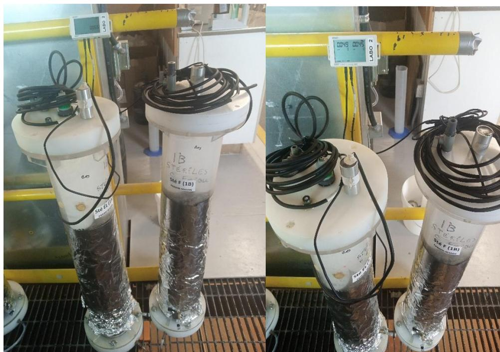
Figure 3.13 Photo de l'essai de consommation d'oxygène
