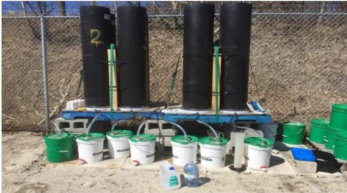
Figure 3.14 Photographie des colonnes durant l'essai sur le terrain (A. Lamontagne, courriel, 20 Aout-2021)
