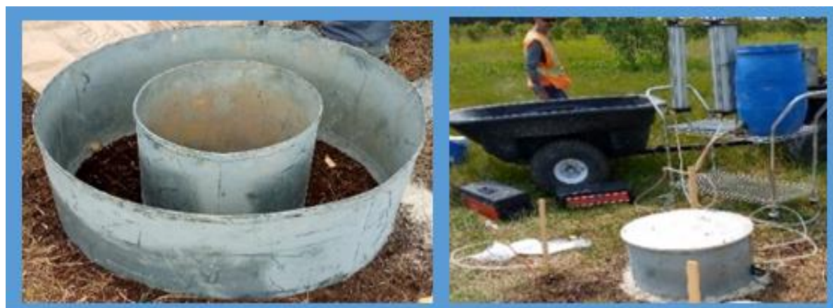
Figure 3.7 Test d'infiltration au double anneau sur les résidus Goldex (Manitou)
