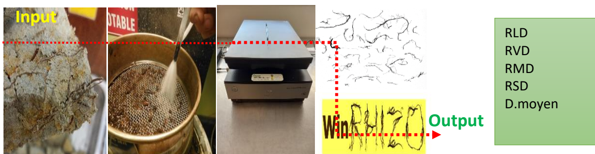
Figure 3.10 Détermination des paramètres racinaires par imagerie avec WinRhizo et après séchage des racines à l'étuve.
