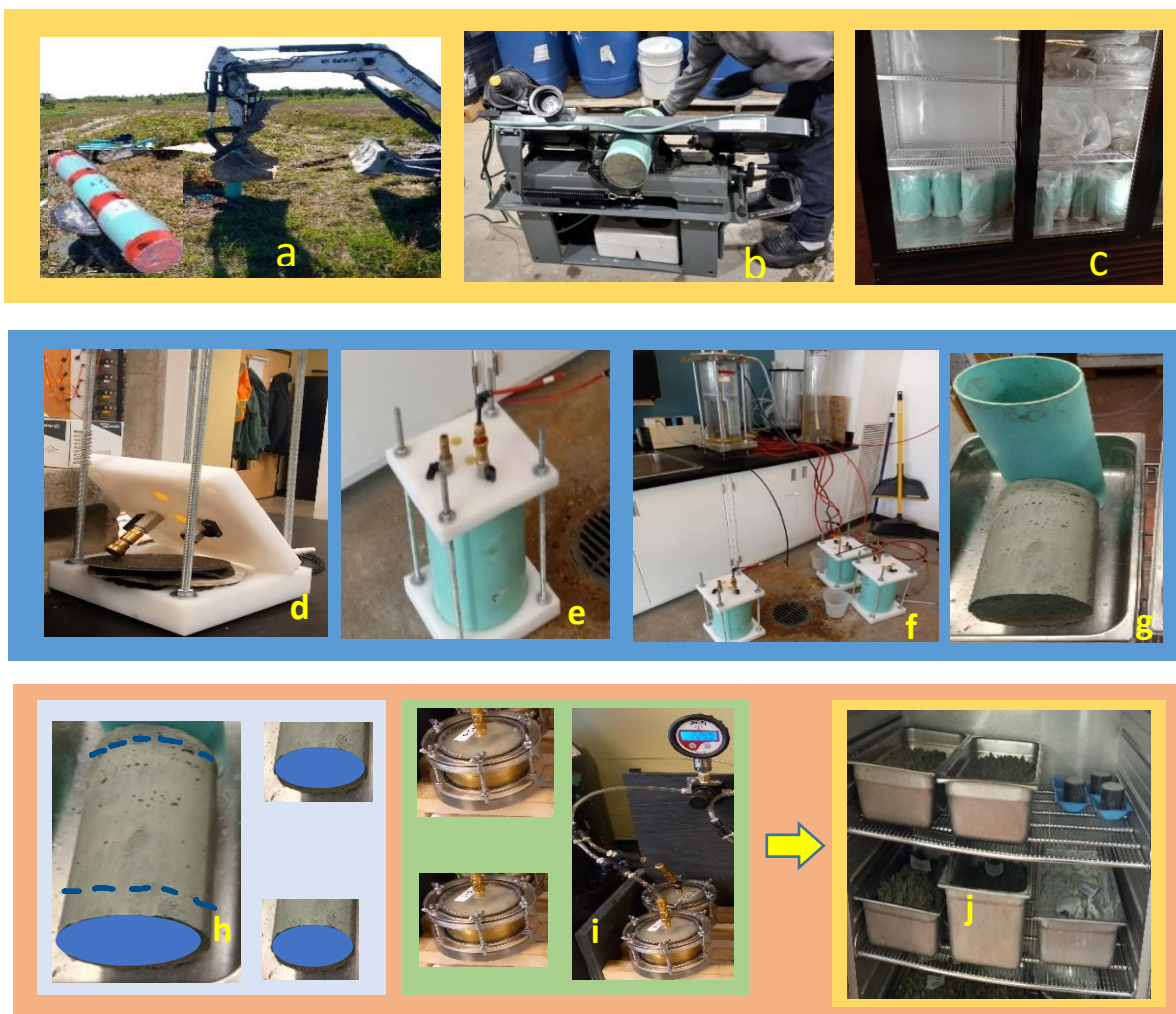
Figure 3.5 a) Prélèvement des carottes non remaniées à la pelle mécanique (site Manitou) ; b) Coupe des carottes à la scie circulaire électrique ; c) Carottes conservées dans le réfrigérateur ; d) Éléments du perméamètre à parois rigides ; e) Échantillon monté sur le perméamètre; f) Saturation des échantillons; g) Carotte saturée et extraite du cylindre après la mesure de k_{sat} ; h) Prélèvement des échantillons pour la mesure de la CRE; i) Mesure de la CRE avec Cellule Tempe; j) Séchage des matériaux après la mesure de la k_{sat} .
