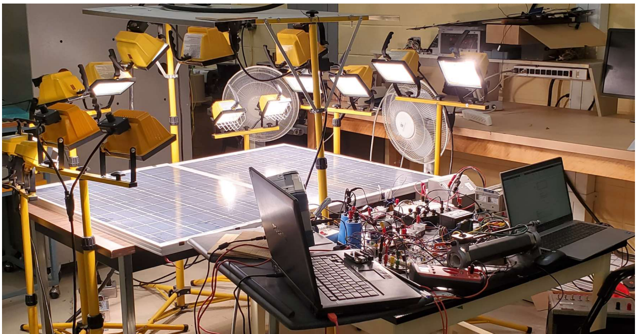
Figure 33: Vue d'ensemble de la plateforme MPPT
