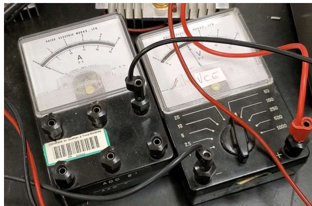
Figure 27: Indicateurs de tension et de courant
