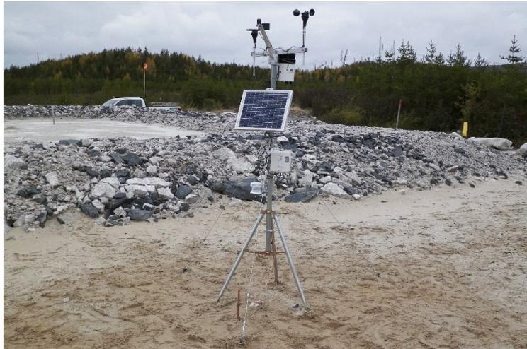
Figure 3.12 Vue de la station de mesures météorologiques après son installation en octobre 2019.
