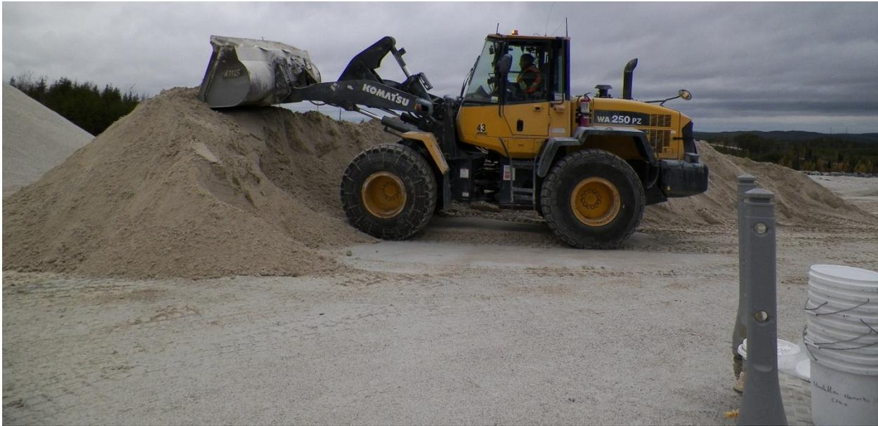
Figure 3.7 Homogénéisation du rejet Flot (octobre 2017).
