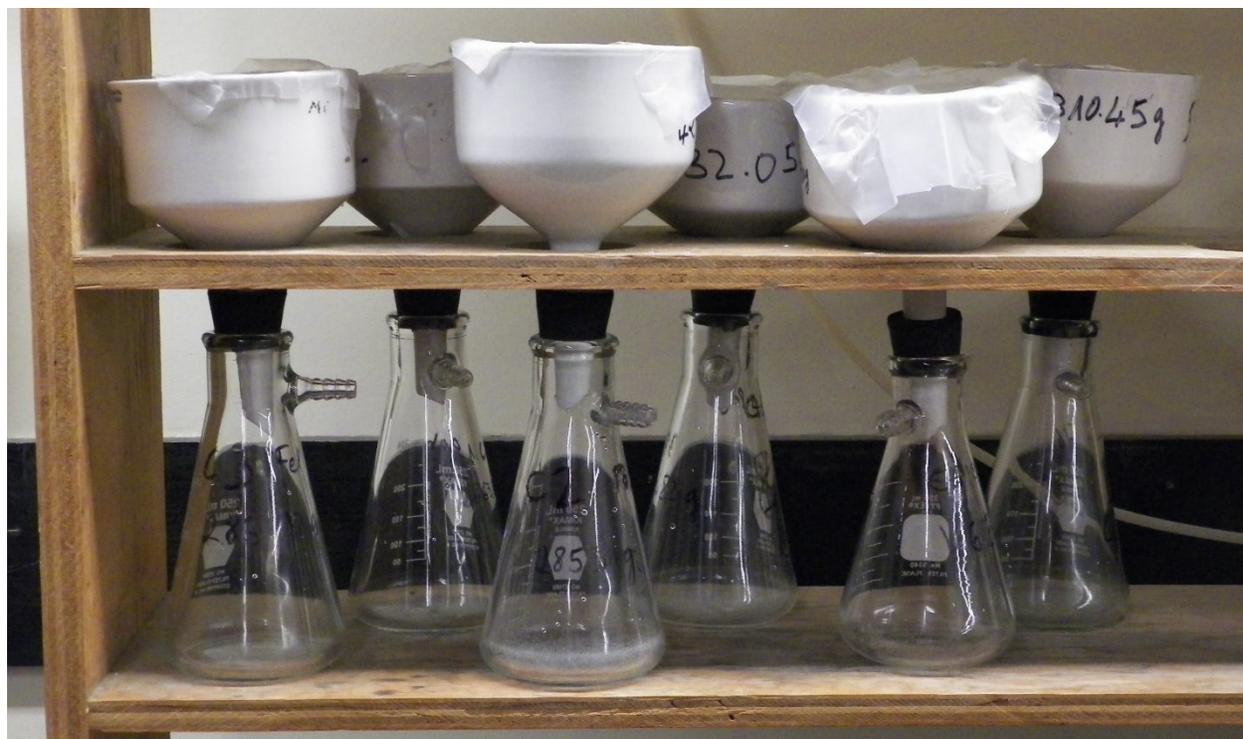
Figure 3.10 Vue de certaines des mini-cellules d'altération utilisées dans le cadre de cette thèse.
