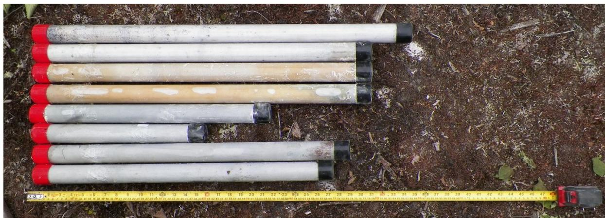
Figure 3.26 Carottes de résidus prélevées lors du forage 4. Le ruban à mesurer fait 1,22 m.
