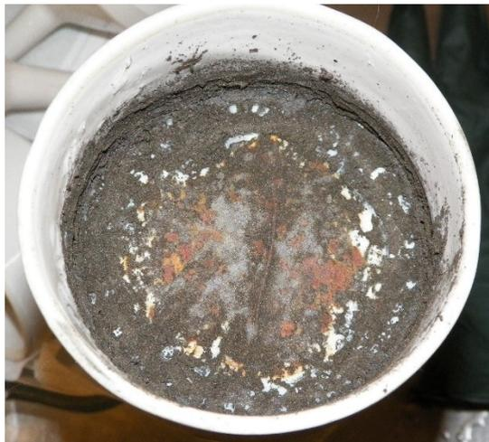
Figure 5.4 Fond de la mini-cellule d'altération de ferrosilicium au terme de l'essai cinétique.
