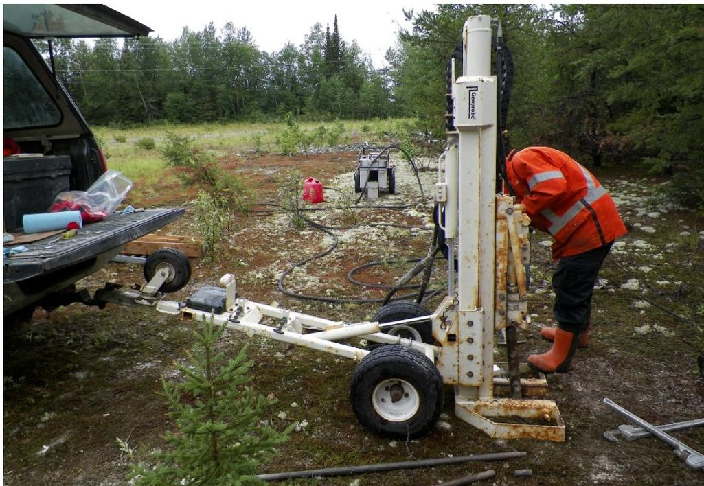
Figure 3.25 Foreuse Geoprobe 540MT en cours d'utilisation au site Québec Lithium.
