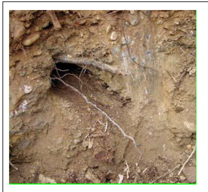
Figure 2.10 Galerie laissée en place par une racine décomposée de peuplier (10 cm de diamètre) dans des matériaux cohésifs (matrice limoneuse) (tirée de Vennetier et al., 2015a)
