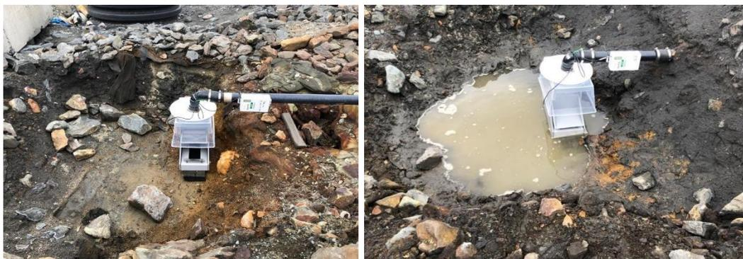
Figure 4–36 Conditions de drainage en aval des débitmètres de la cellule 1 (gauche) et la cellule 3 (droite) le 30 juin 2022.
