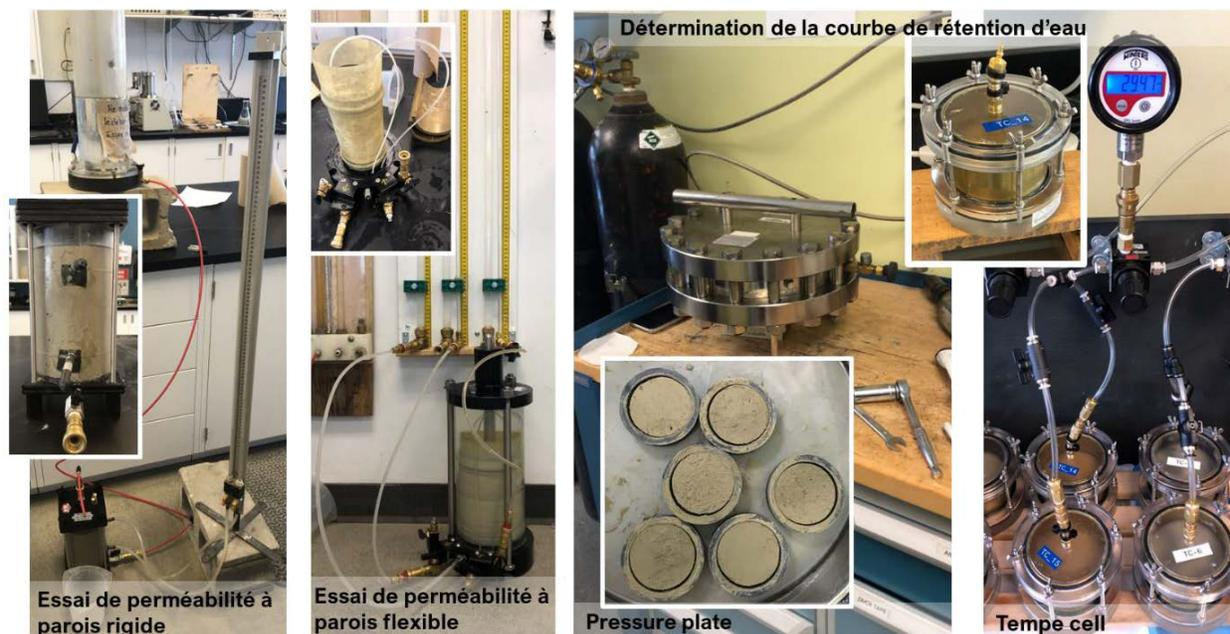
Figure 3–22 Montage des différents essais utilisés dans la caractérisation hydrogéologique.
