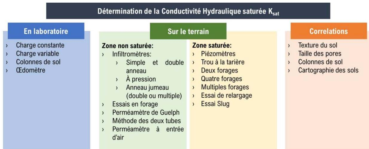
Figure 2–11 Méthodes utilisées pour déterminer la conductivité hydraulique saturée.
