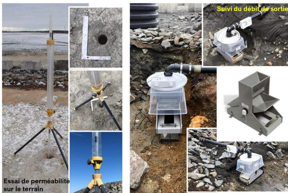
Figure 3–6 Assemblage du perméamètre de Guelph pour la mesure de la conductivité hydraulique in situ. Installation des débitmètres à la base des cellules.
