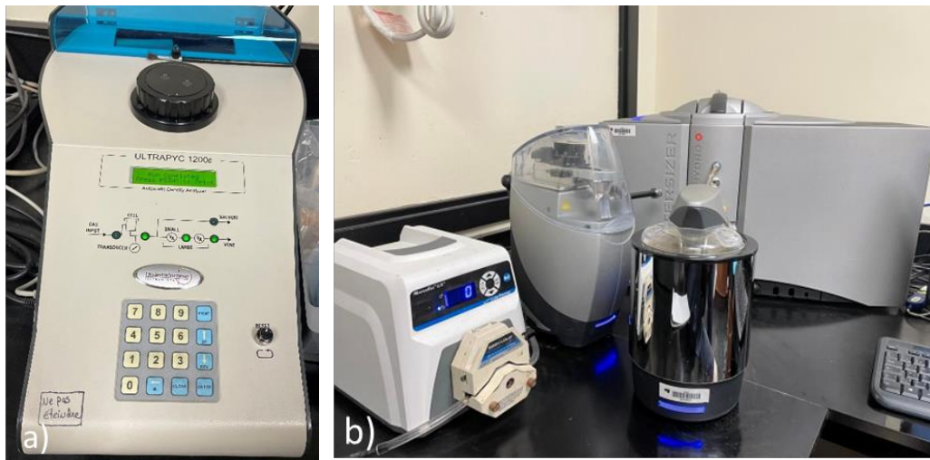
Figure 3-4 Appareils de caractérisation physique des résidus : a) pycnomètre à hélium; b) granulomètre au laser Mastersizer 3000 de Malvern Panalytical
