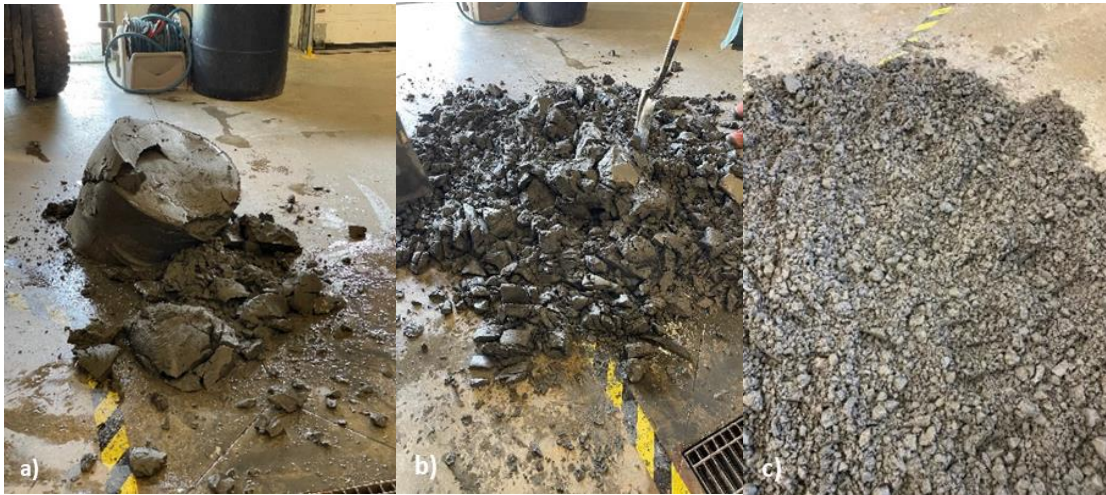
Figure 3-1 Homogénéisation des résidus : a) résidu non homogénéisé; b) résidus en cours d'homogénéisation; c) résidu bien homogénéisé
