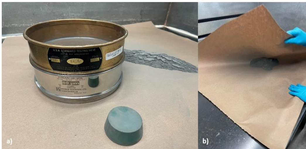
Figure 3-2 Préparation des résidus pour la caractérisation physique a) agglomération des résidus; b) homogénéisation par la méthode de quatre points
