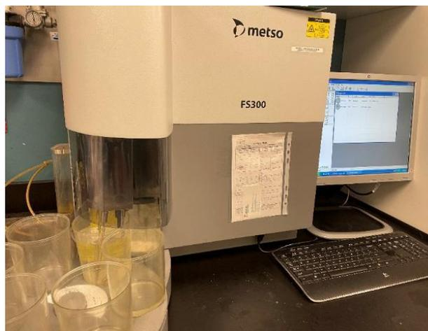
**Figure 2.10 :** *Analyseur de la qualité de la fibre (AQF) de type Kajaani FS3001M (Metso, Helsinki, Finlande)*
