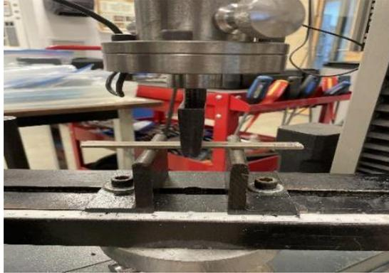
**Figure 2.14** : Dispositif de flexion sur le banc d'essai mécanique universel (Zwick/Roell Z020, Ulm, Allemagne)
