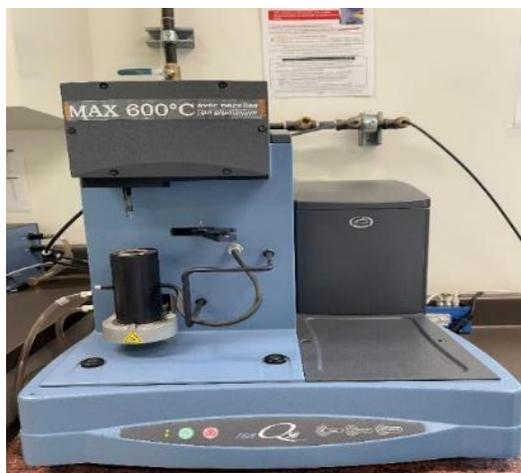
**Figure 2.15 :** *Appareil d'analyse thermogravimétrique, modèle Q50 (TA Instruments, New Castle, États-Unis)*
