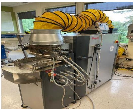
**Figure 2.3 :** *Mélangeur Haake Rheomix (Thermo Scientific, Massachusetts, États-Unis) lié à un système de ventilation*
