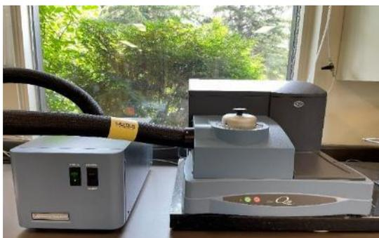
**Figure 2.16 :** *Appareil de calorimétrie différentielle à balayage, modèle Q20 (TA Instruments, New Castle, États-Unis)*
