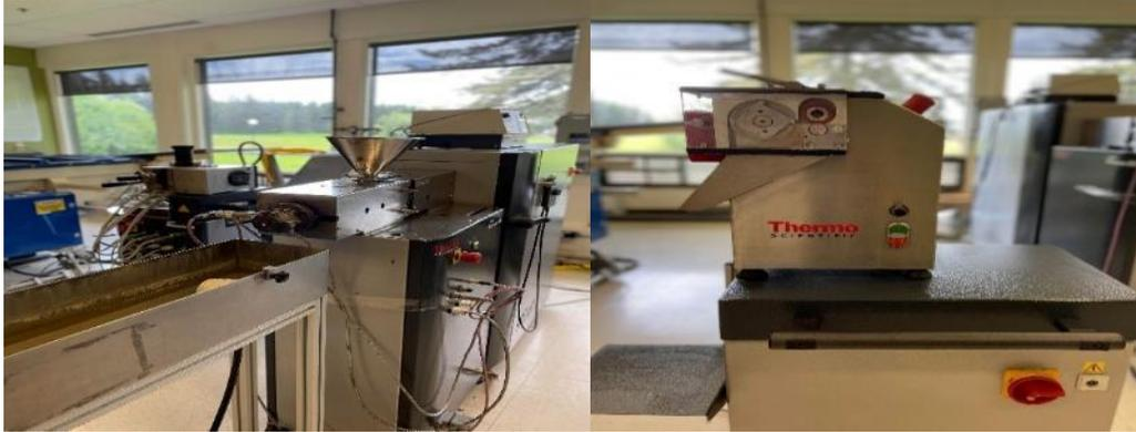
**Figure 2.6 :** *Extrudeuse à double vis (Thermo Scientific™ HAAKE Rheomex PTW OS, Karlsruhe, Allemagne) et Broyeur à couteaux rotatifs*
