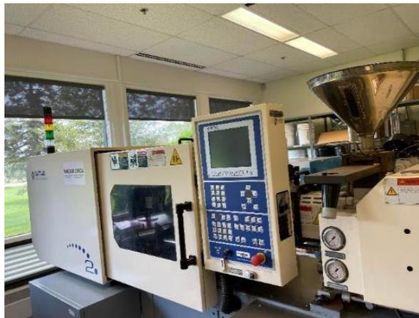
**Figure 2.7 :** *Machine de moulage par injection (Haitian MA600II/130, Ningbo, Chine)*
