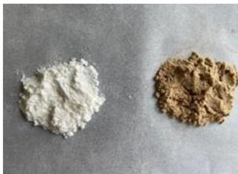
**Figure 2.2 :** Les différentes fibres utilisées (à gauche fibres issues du procédé kraft; à droite fibres issues d'un procédé thermomécanique)
