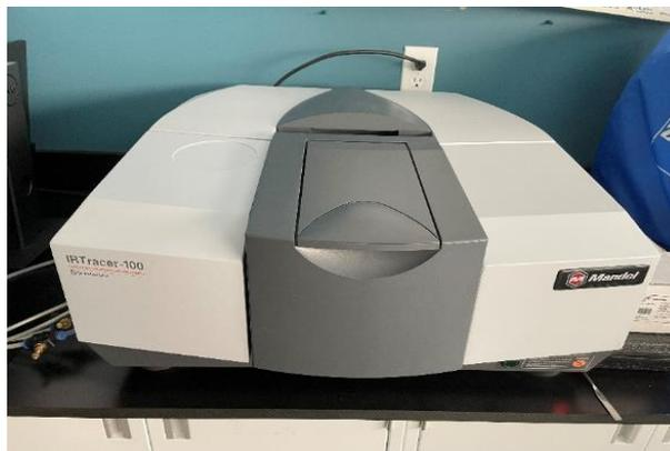
**Figure 2.18 :** *Appareil IR Tracer 100 (Shimadzu, Kyoto, Japan) pour l'analyse de chimie de surface par spectroscopie infrarouge à transformée de Fourier (FTIR)*
