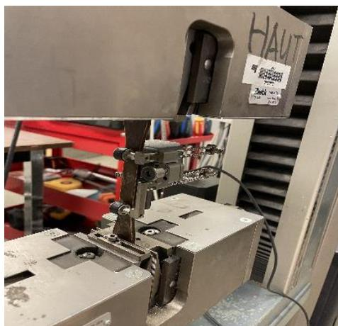
**Figure 2.13 :** *Dispositif de traction sur le banc d'essai mécanique universel (Zwick/Roell Z020, Ulm, Allemagne)*
