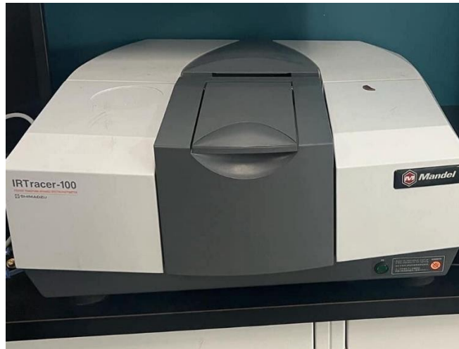
Figure 2.7 : Appareil de spectroscopie infrarouge à transformée de Fourier de l'UQAT (Shimadzu IR Tracer-100, Kyoto, Japon)
