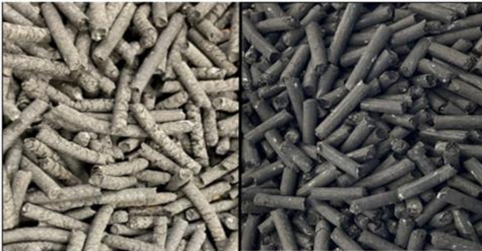
Figure 2.4 Aspect des granules avec deux diamètres de canaux différents (photo de gauche d = 3 mm et photo de droite d = 6 mm).
