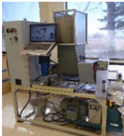
Figure 2.2 La granuleuse GEMCO avec ses différentes composantes
