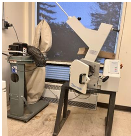
Figure 2.1 Broyeur à couteaux RETSCH du laboratoire biomatériaux à la Sarre
