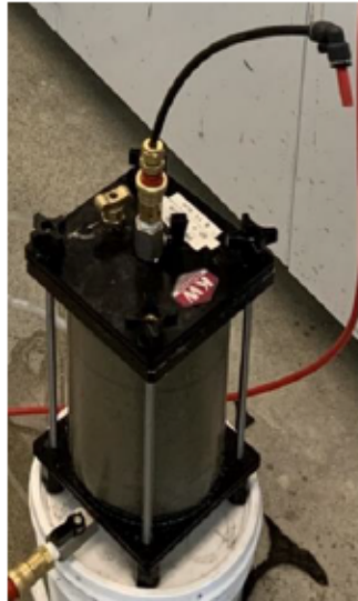
Figure 16 Perméamètre à parois rigides
