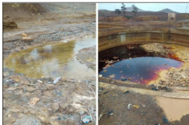
Figure 2 Drainage minier acide, dans la mine de Kettara – Maroc d'après (Nfissi et al., 2018)
