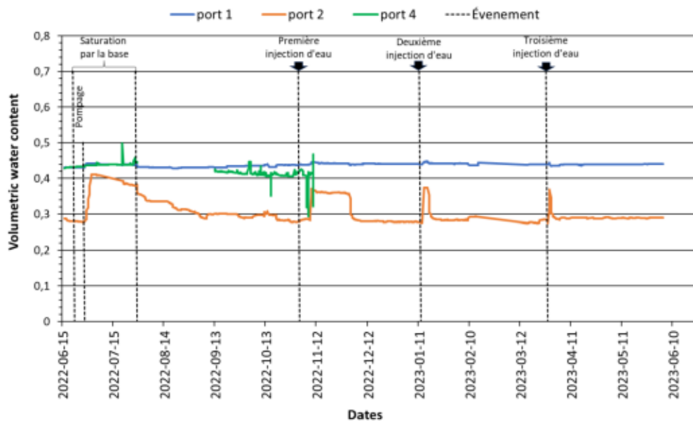
Figure 45 Teneurs en eau volumiques mesurées dans la colonne simulant le recouvrement d'argile sans amendement
