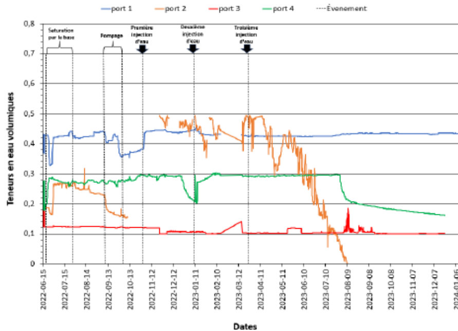
Figure 57 Teneurs en eau mesurées au niveau de la colonne simulant le recouvrement construit avec de l'argile amendée avec 25% de sable fin
