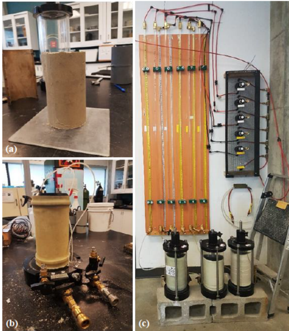
Figure 3.15 Mise en place (a et b) de l'échantillon dans le perméamètre et saturation de l'échantillon et prise des mesures (c).
