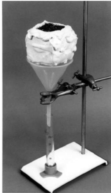
Figure 2.22 La méthode du cube modifié et le dispositif expérimental pour la détermination de la k_{sat} .
