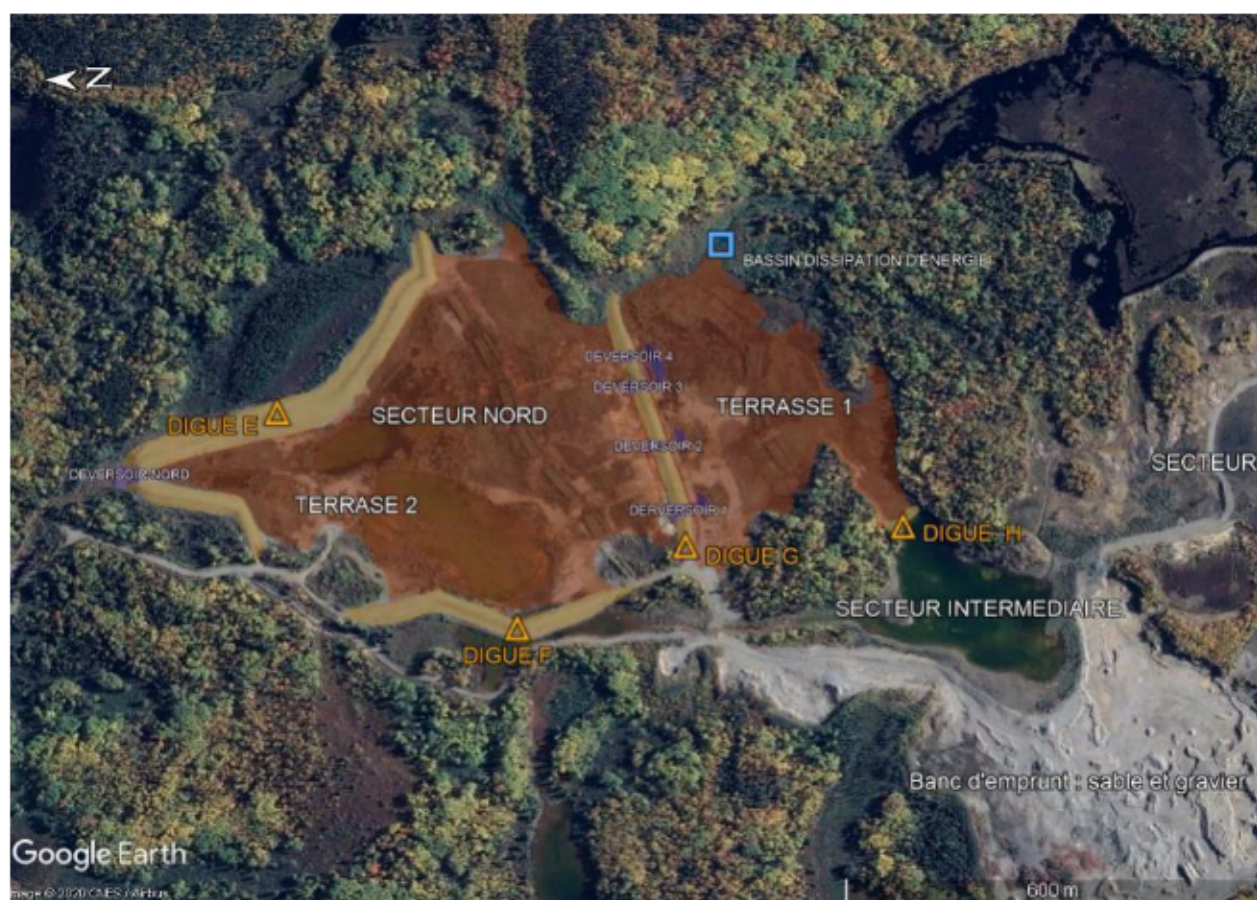
Figure 3.6: Empreinte des résidus miniers du secteur Nord (orange). La terrasse 1 est séparée de la terrasse 2 par la digue G. L'effluent final du parc se déverse au déversoir Nord. Le banc d'emprunt de sable et gravier est situé au sud-ouest du parc à résidus.
