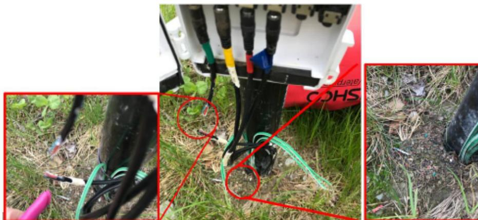
Figure 7.6 Représentation des instruments endommagés par des animaux
