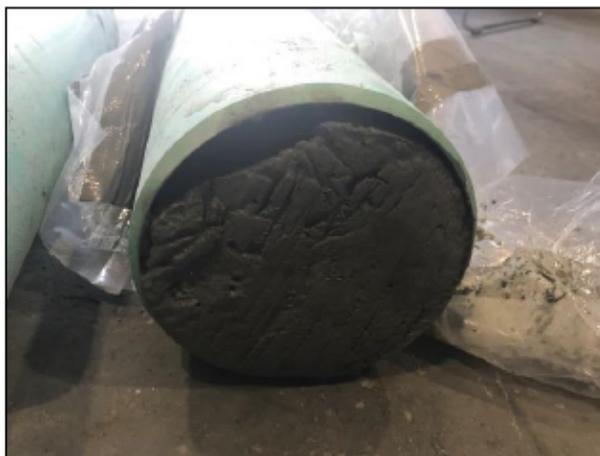
Figure 7.10 Vue d'un échantillon perdu en raison de la consolidation
