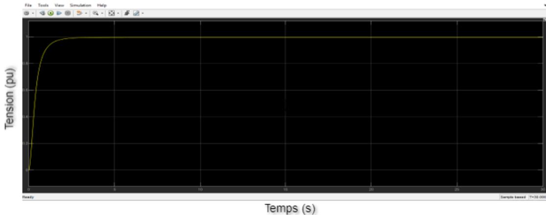
Figure 42: résultat de la simulation de la régulation de la tension de l'alternateur par l'AVR et le régulateur flou.
