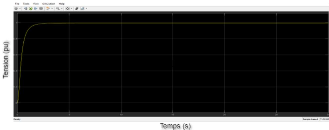
Figure 51: résultat de la simulation de la régulation de la tension de l'alternateur par l'AVR et le régulateur neuronal.
