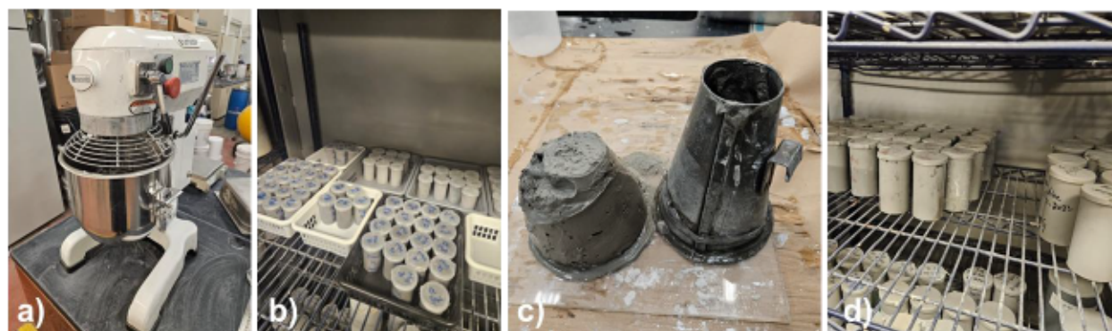
Figure 3.14 Préparation et conditionnement des RPC : a) Malaxage du RPC à l'aide d'un malaxeur Eurodib, b) Mise en moules cylindriques (1,2 po × 2,36 po), c) Mesure de l'affaissement (slump) à l'aide du petit cône d'Abrams et d) Mise en moules cylindriques (2 po × 4 po)
