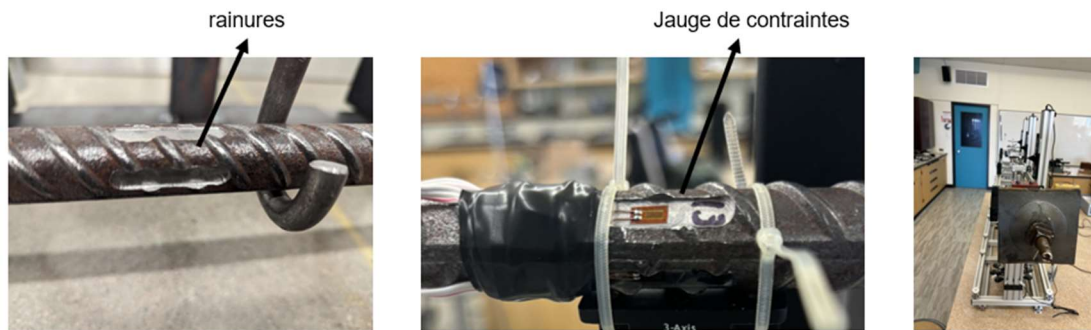
Figure 5.7 Procédure d'échantillonnage du boulon instrumentée au laboratoire
