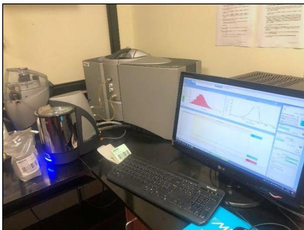
Figure 3.10 Granulomètre laser Malvern Panalytical Mastersizer 3000 (URSTM).
