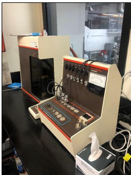
Figure 3.17 Mesureur de surface spécifique Gemini 2375 de Micromeritics de l'URSTM.
