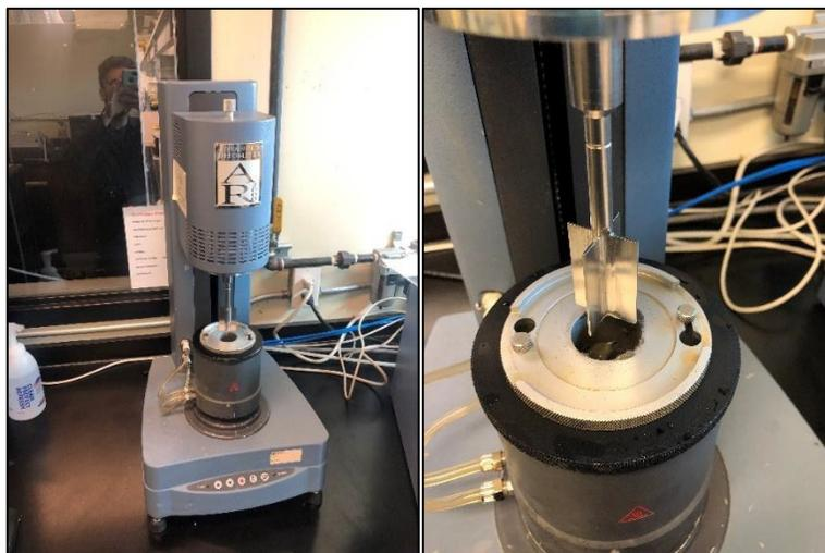
Figure 3.32 Rhéomètre AR2000 (TA Instrument) de l'URSTM, UQAT.
