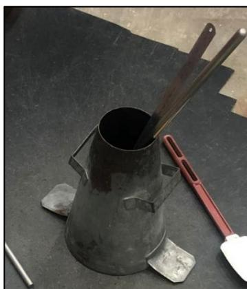
Figure 2.15 : Cône d'Abrams selon ASTM C143-15 (2015).
