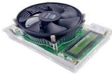
Figure 26 : Charge électronique utilisée dans le banc d'essai. 77
