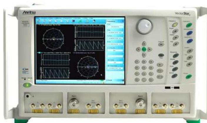
Figure. 3.3 Analyseur de réseaux ANRITSU MS4647A.
