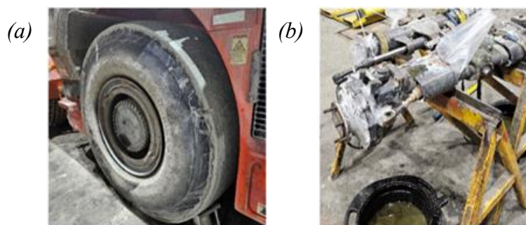
Figure 4.13 (a) Usure des pneus ; (b) Dysfonctionnement du système hydraulique de propulsion
