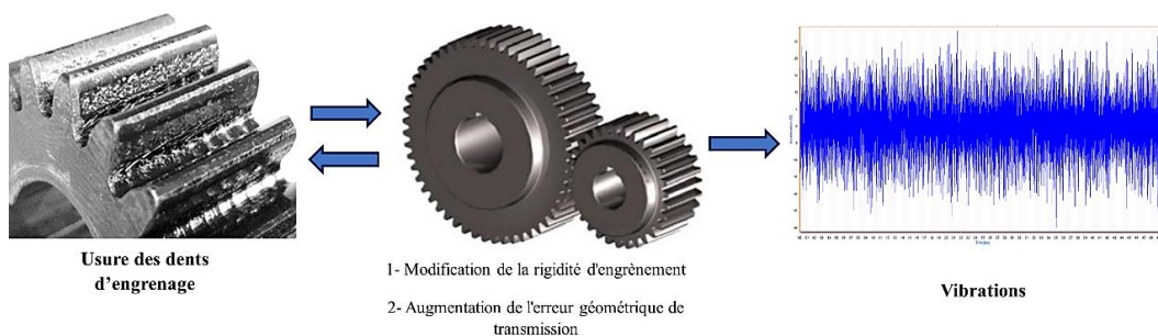
Figure 2.8 Influence de l'usure des dents d'engrenage sur la dynamique des vibrations du réducteur [31]
