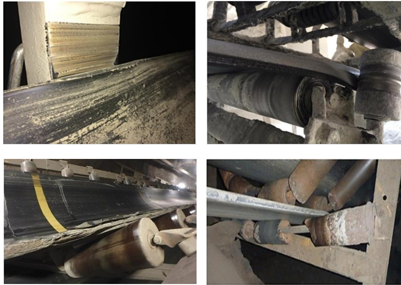
Figure 2.6 Abrasion de la courroie due aux interactions avec la structure du convoyeur et ses composants [28]
