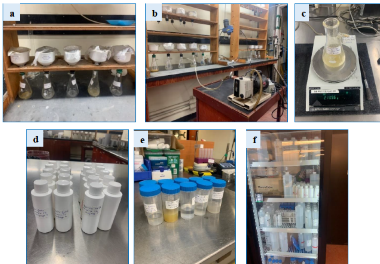
Figure 3.6. Essai en minicellules d'altérations en condition oxygène. a) mini-cellules d'altération pendant la lixiviation; b) extraction du lixiviat par pompage; c) mesure de la masse du lixiviat recueilli; d,e) lixiviats conservés dans des contenants en polystyrène; f) conservation des lixiviats au froid à 5 °C.
