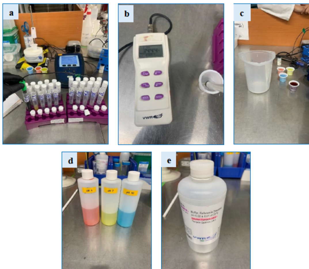
Figure 3.8. Mesure du pH, de Eh et de la CE. a) mesure du pH, de Eh et de CE des lixiviats; b) conductivimètre (ou multi-paramètre); c) calibrage des appareils de mesure; d) liquides de calibrage de pH; e) liquide (à pH 5) de confirmation du calibrage.
