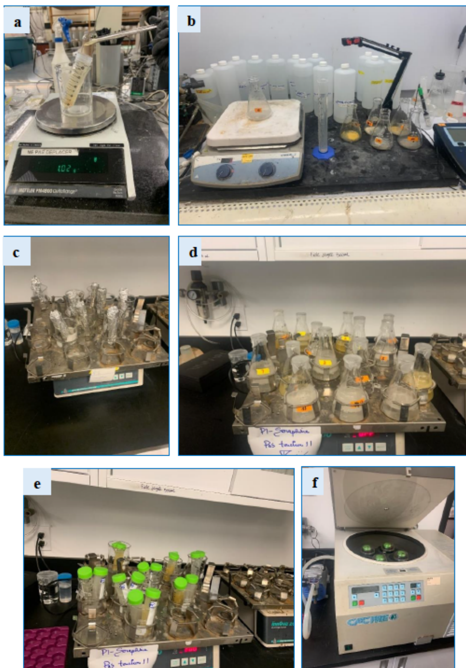
Figure 3.15. Extraction en parallèle sur les résidus post-essais. a) introduction d'un 1g d'échantillon post-essais dans un tube; b) mélange de la solution extractrice avec l'échantillon ; c) tubes d'extraction recouverts de papier aluminium placés sous agitation ; d) fioles Erlenmeyers d'extraction placés dans la plaque agitatrice ; e) tubes d'extraction agités à la lumière ; f) extractions placées dans la centrifugeuse.
