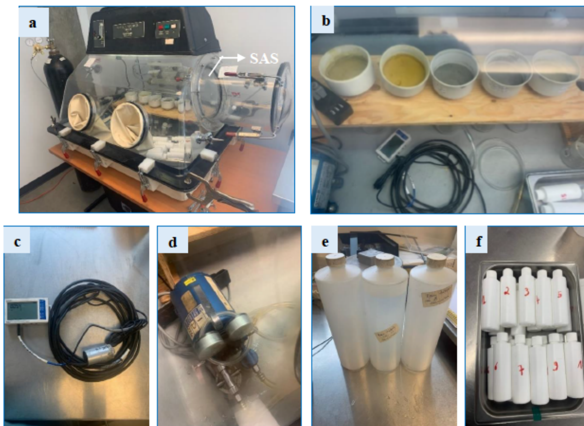
Figure 3.7. Essais en minicellules d'altération en condition anoxiques. a,b) mini-cellules d'altération en pompage dans la chambre à atmosphère contrôlée (CAC); c) senseur d'oxygène; d) pompe à vide; e) contenants d'eau déionisée et désaérée dans la CAC; f) contenants de conservation des lixiviats dans la CAC.
