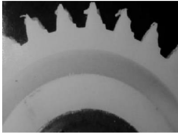
Figure II.17 : Usure des dents d'un engrenage en polymère [44].
