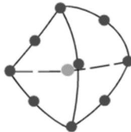
Figure III.11: Éléments volumique parabolique.
