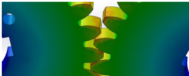
Figure IV.6: Répartition des déplacements résultant sur les dents d'un engrenage
