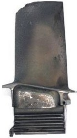
Figure 8 : Exemples de dommages thermiques sur des aubes de turbines à gaz (zone de surchauffe du matériau à l'extrémité du bord d'attaque)[26]
