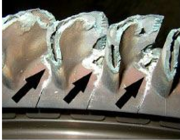
Figure 10: Fissures par corrosion au niveau des pales [28]
