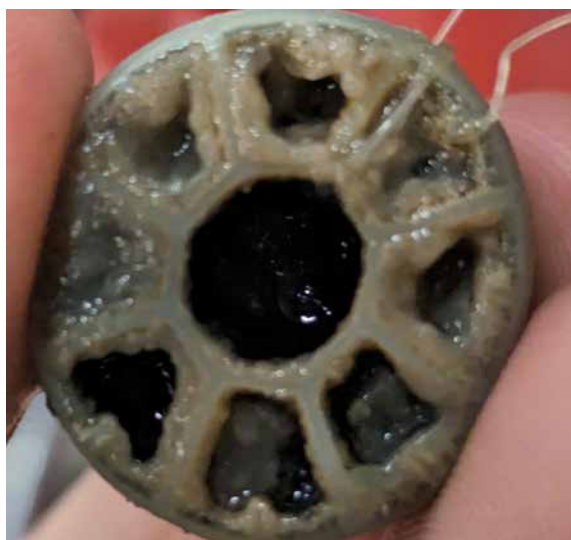
Figure 5.1 : Photographie d'un média du réacteur R4 montrant une stratification des populations biologiques
