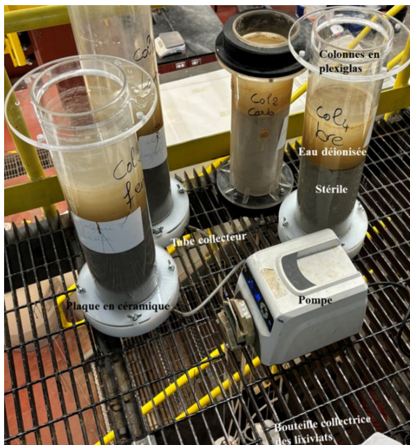
Figure 2.11 : Photographie de colonnes d'essai
