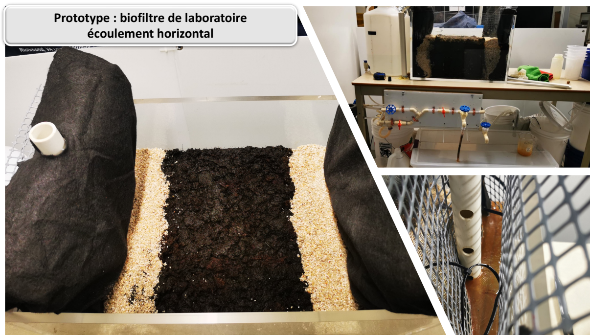
Figure 26 Prototype, biofiltre à écoulement horizontal.
