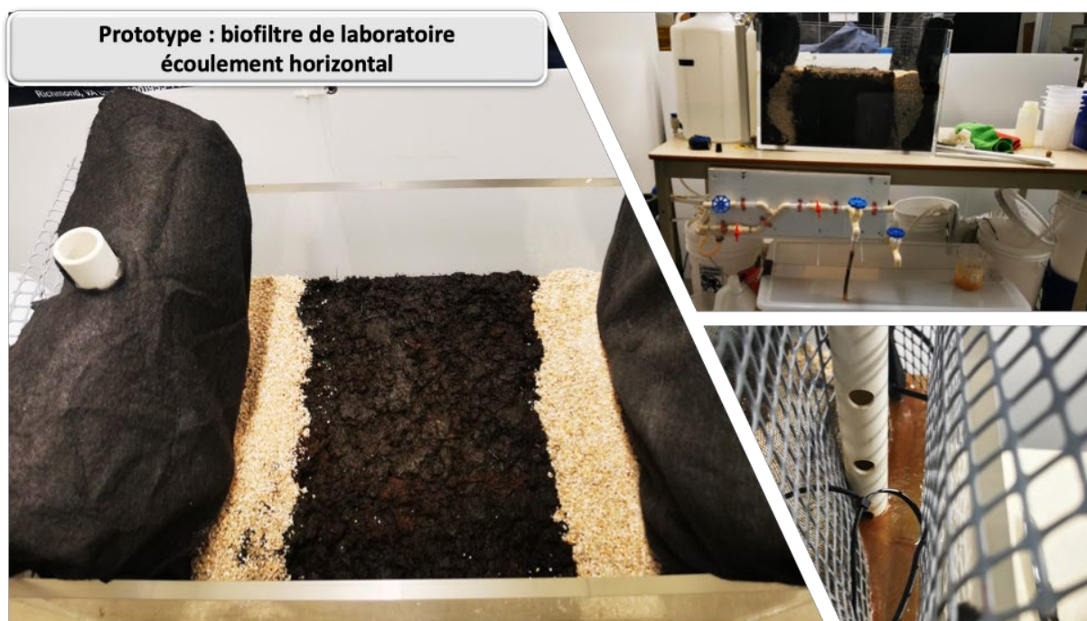
Figure 26 Prototype, biofiltre à écoulement horizontal.
