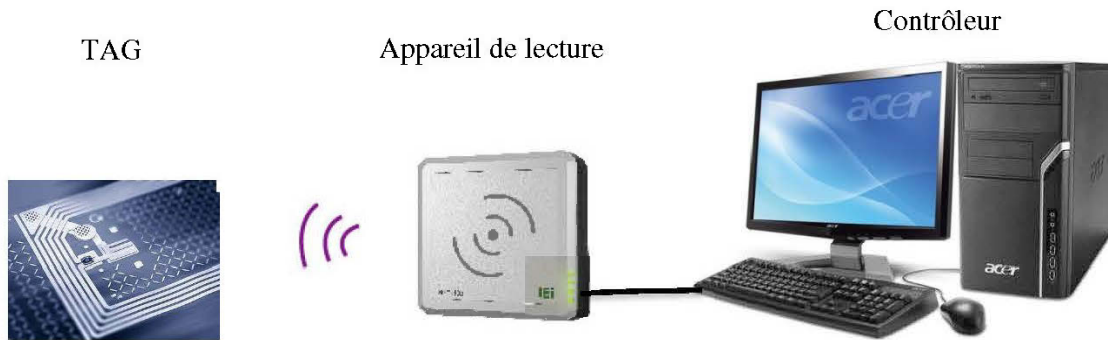
Figure 14 : Les composants d'un système RFID
