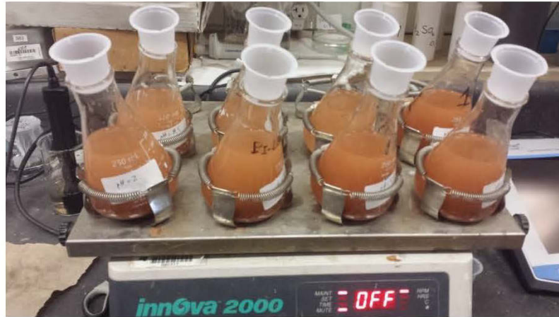
Figure 3.13 Échantillons en agitation lors du test de dépendance au pH.
