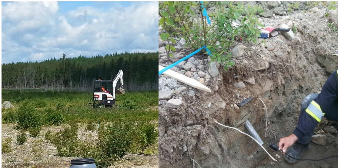
Figure 6.1 Insertion des sondes à oxygène sous les individus d'intérêt pour mesurer l'impact des racines sur les concentrations d'oxygène dans la CP.
