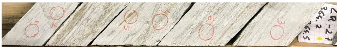
**Figure 2-7 : Exemples de points d'analyses pour la FRX sur un échantillon de la série LaRonde Zone 5**
