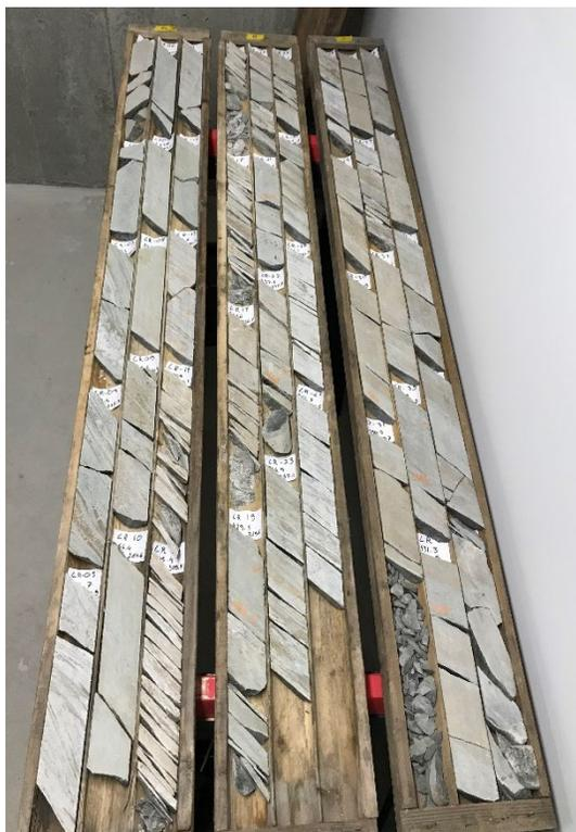
**Figure 2-1 : Identification et rangements des carottes de forage**
