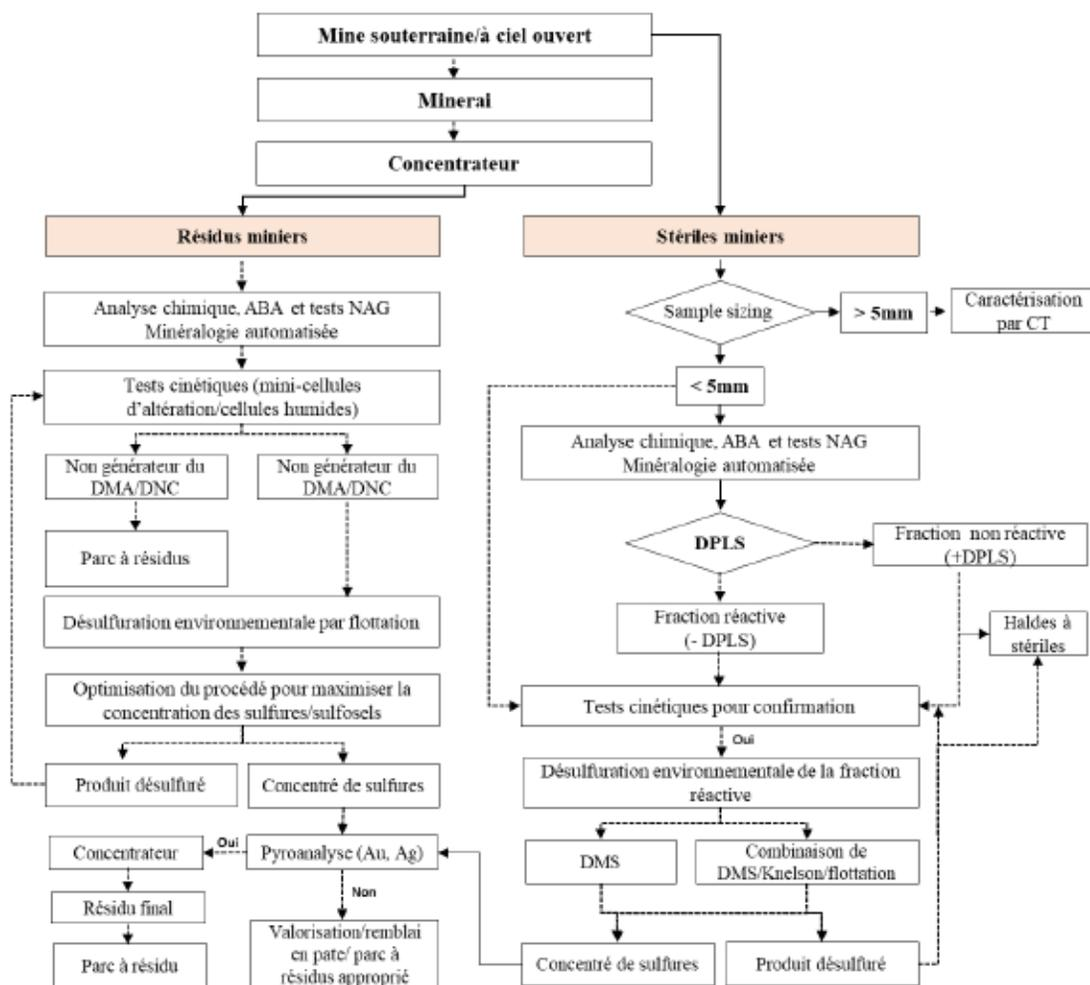
Figure 8.1 Schéma de l'approche proposée pour la gestion intégrée des rejets miniers
