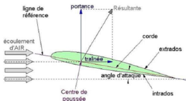
Figure 15 Application des forces sur le profil d'aile.
