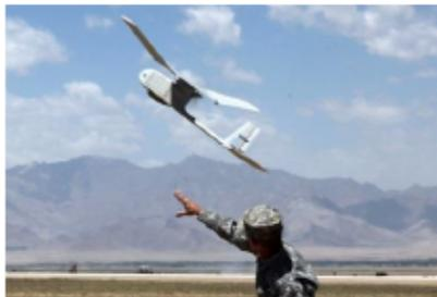
Figure 6 Drone RQ-11 Raven.
