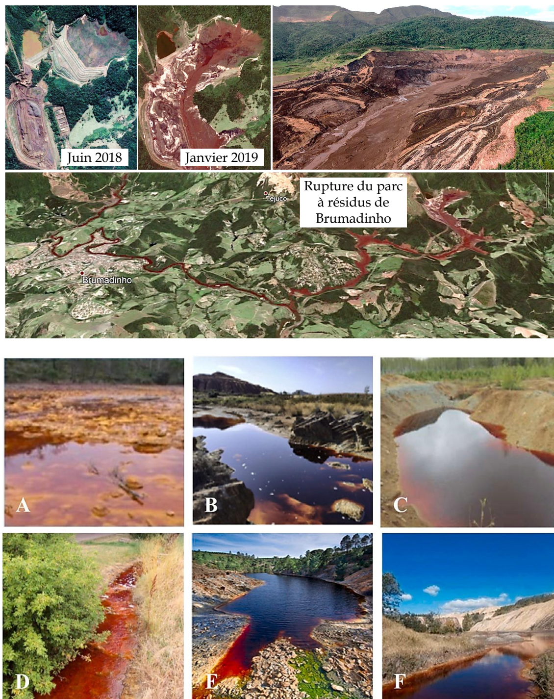
FIGURE 1.2 Images satellites Google Earth du parc à résidus de Brumadinho au Brésil avant et après rupture. Photographies montrant l'impact du drainage minier acide, adapté de Chen et al. (2021). Photographies tirées initialement de A - Yan et al. (2020), Australie, B - González et al. (2020), Espagne, C - Bortnikova et al. (2020), Russie, D - Sandlin et al. (2020), États-Unis, E - López et al. (2021), Espagne et F - Markovic et al. (2020), Serbie.
