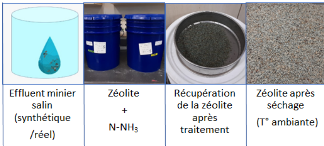
Figure C.1 Production de zéolite riche en N
