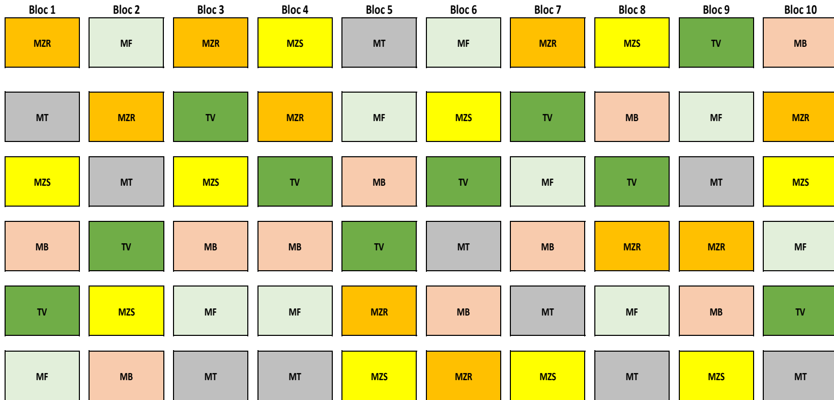
Figure 3.3 Dispositif RCBD utilisée pour les essais de revégétalisation
