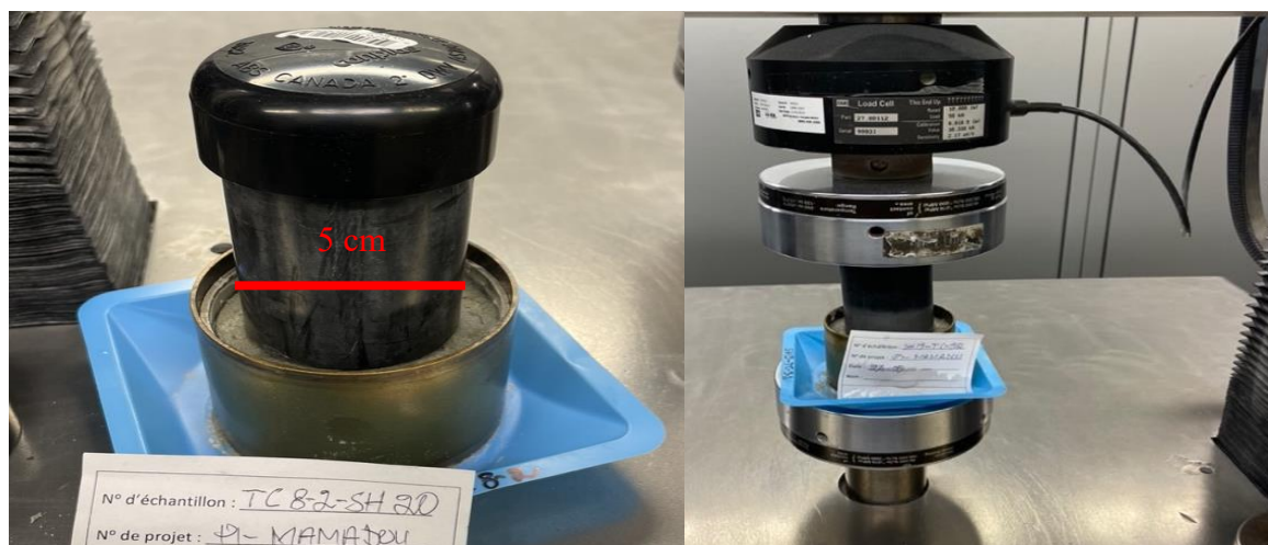
Figure 3.14 Sous-échantillonnage pour les analyses de tomographie
