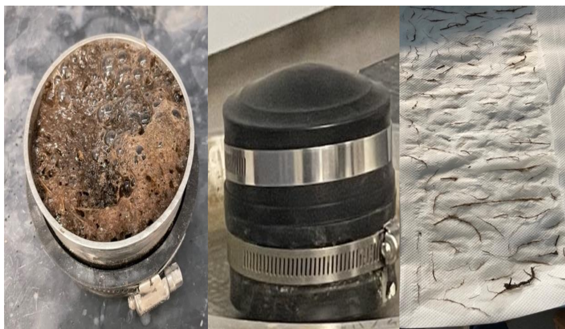
Figure 3.25 Tentative de destruction des racines de saules et herbacées contenues dans les résidus Goldex à l'aide du peroxyde d'hydrogène 50%
