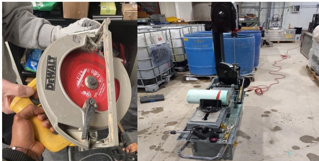
Figure 3.8 Découpage d'un échantillon à l'aide d'une scie circulaire et droite
