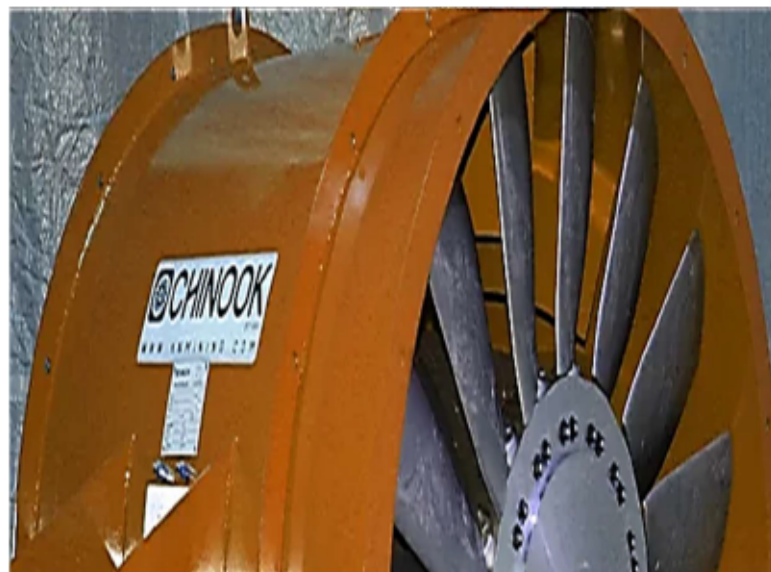
Figure 1 : Ventilateur minier axial de type chinook [1]
