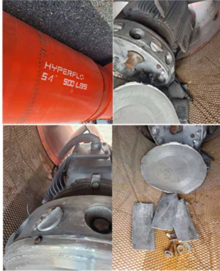
Figure 52 : Pales réelles endommagées
