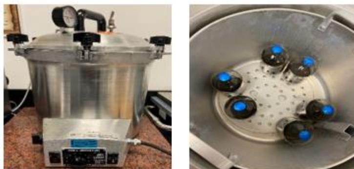
Figure 2.8 : Système d'extraction de la lignine KLASON via un autoclave de type presto/cuiseur rapide (VWR Canada)
