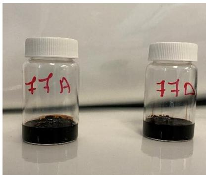
Figure 2.7 : Poudre de bois imprégnée avec l'acide sulfurique
